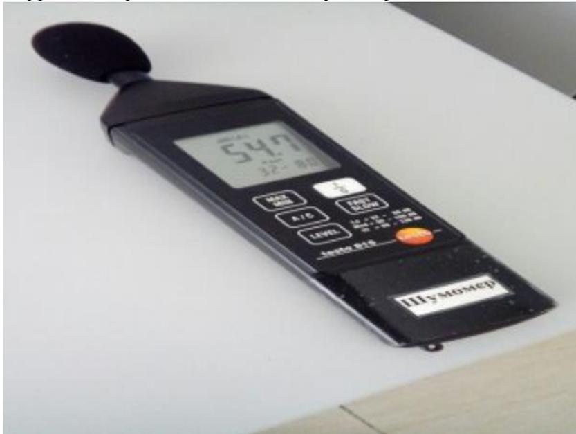
Рис. 1. Шумомер testo 815
