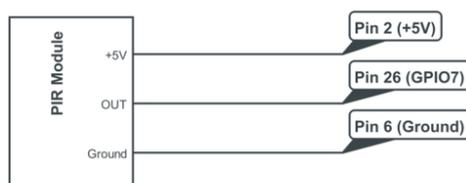
Рис. 2 Подключения датчика движения к Raspberry Pi
