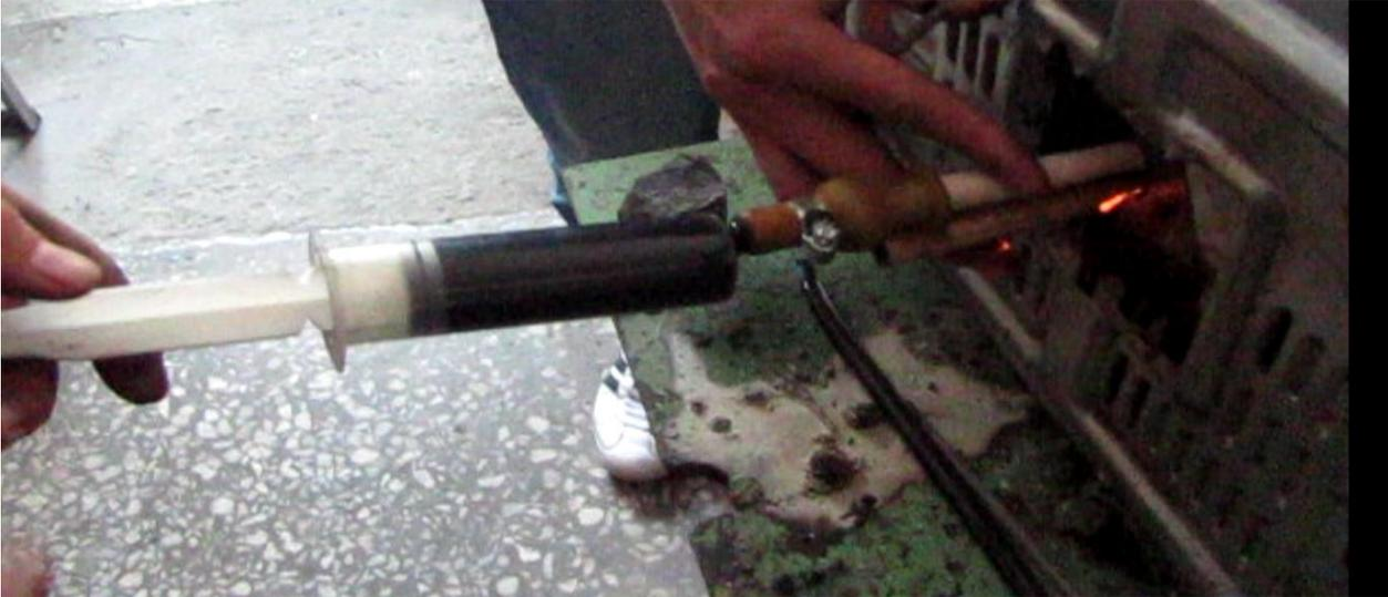
Рис.2. Подача нефти в керамическую трубу плазматрона.
