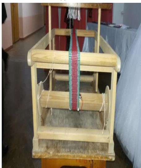
Рис.5 Экспериментальный станок для ткачества
