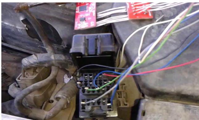
Рис. 5. Подключение адаптированного ELM 327 к компьютеру машины
