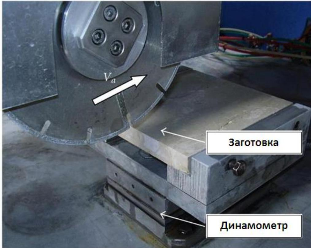
Рис. 1: Механическая обработка камня.
