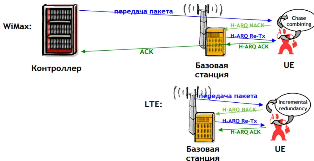
Рис.1.8. Процедура HARQ (Hybrid Automatic Repeat reQuest)
