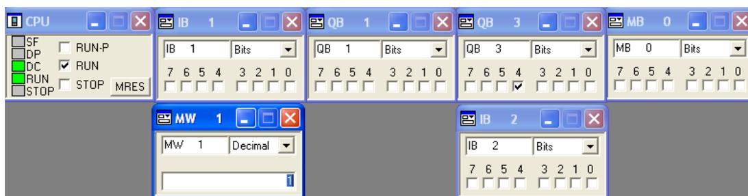
Рис 6. Симулятор Simatic Step 7.
