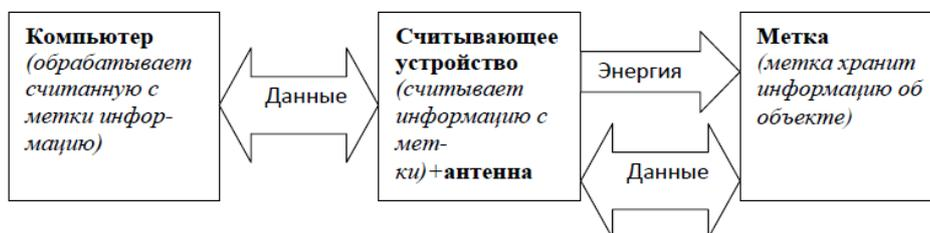
Рис. 1. Принцип работы RFID- системы
